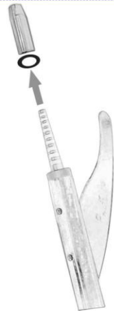
21. Снимите гайку держателя гребного винта
