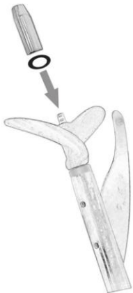
22. Вставьте и зафиксируйте гребной винт
