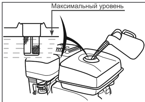
Рис. 5 Максимальный уровень топлива в топливном баке
