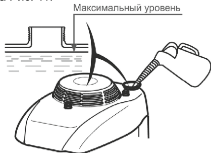
Рис. 11 Максимальный уровень топлива в топливном баке
