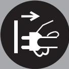
Всегда отключайте все устройства от генератора перед выполнением работ по техническому обслуживанию, когда отходите от устройства и после его выключения.
