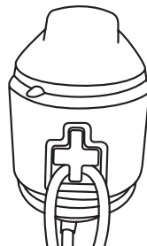
Рис. 11. Крепление кабеля удлинителя
