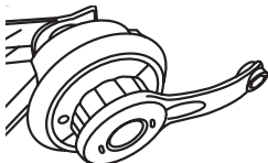
Рис. 14. Откручивание головки при помощи ключа
