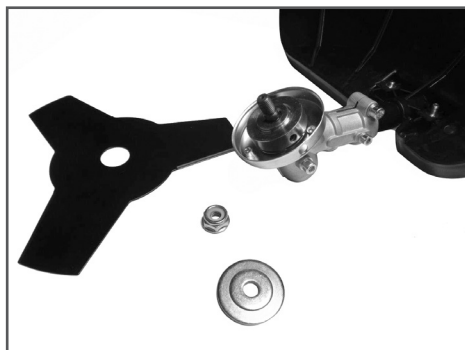
Рис. 8. Установка защитной шайбы
