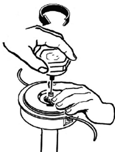
Рис. 19. Закручивание винта крепления триммерной головки
