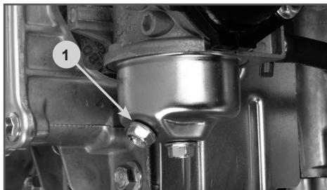
Рис. 14 Слив топлива из карбюратора
