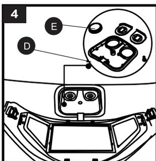
Вытащите крышки батарейных отсеков, находящиеся с внутренней стороны маски (с обратной стороны панели управления (D)). Извлеките элементы питания CR2450 (E). Установите новые элементы питания в такое же положение, как и были установлены (знаком «+» во внешнюю сторону). Установите крышки батарейных отсеков на место.
