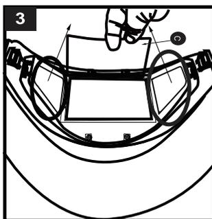
Извлеките защитное стекло (С) из фиксаторов на АСФ. Установите новое защитное стекло (С), после этого замените боковые защитные стёкла.
