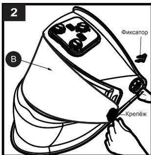
Установите новое защитное стекло (В), установите крепёж защитного стекла, установите фиксатор крепежа.
