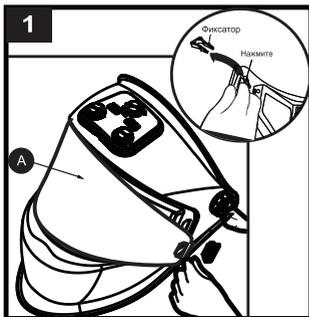
Разблокируйте фиксатор крепежа защитного стекла (А). Выньте крепёж, выньте защитное стекло (А).
