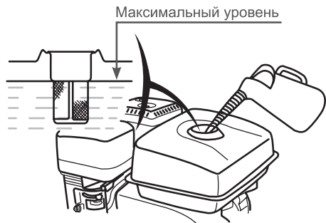
Рис. 6. Максимальный уровень топлива в топливном баке
