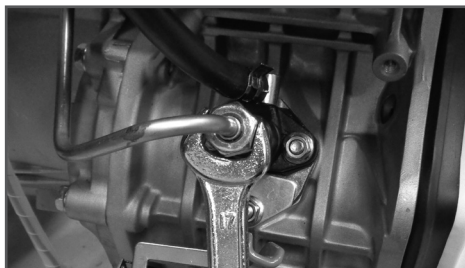
Рис. 12 Удаление воздуха из топливного насоса
