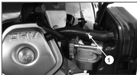
Рис. 14 Трубка системы вентиляции картера
