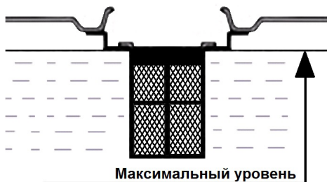
Рис. 10 Максимальный уровень топлива в топливном баке
