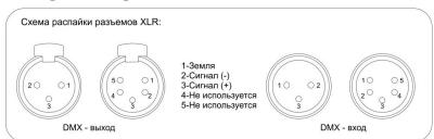
При подключении устройства в режиме Master/Slave, количество приборов в цепи не должно превышать 32 шт. Максимальная рекомендованная дистанция цепи – 500 м.
