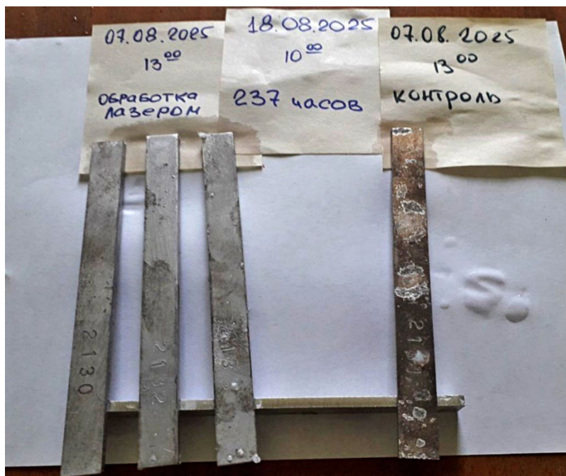
Рис. 2. Результаты испытаний по ГОСТу на коррозионную стойкость сплава АМЦ
