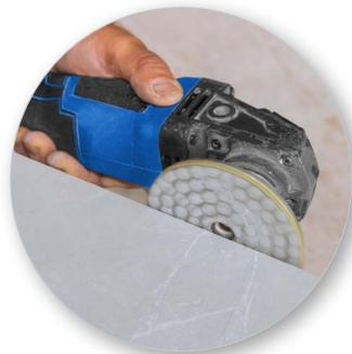
**Алмазные гибкие шлифовальные круги (АГШК)** – расходный материал, который устанавливается на углошлифовальную машину и используется для шлифования и полировки изделий из натурального и искусственного камня. Из-за специфического рельефа алмазные гибкие круги в среде профессионалов получили название «алмазные черепашки по камню».
