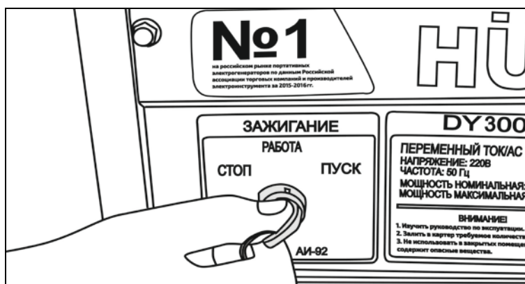
Рис. 17. Запуск двигателя электростартером
