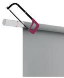
ПРИ ПОМОЩИ НОЖОВКИ ОБРЕЗАТЬ
