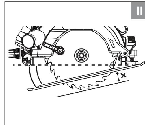
5. Регулировка угла наклона пиления
