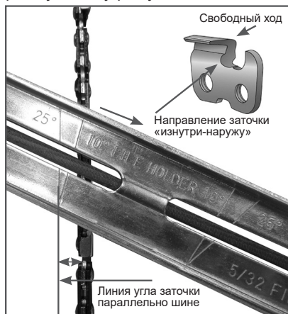
Рис. 19 Определение угла заточки
