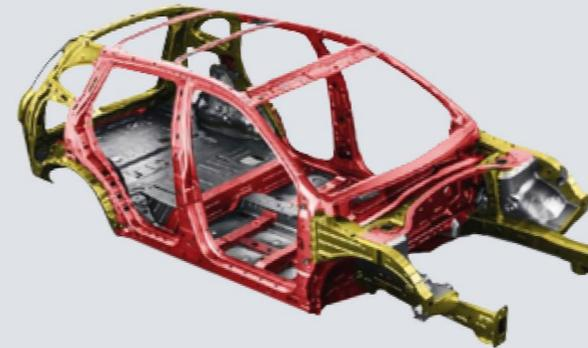
Москвич Ze имеет прочную силовую структуру кузова — доля высокопрочных сталей достигает 70%.
