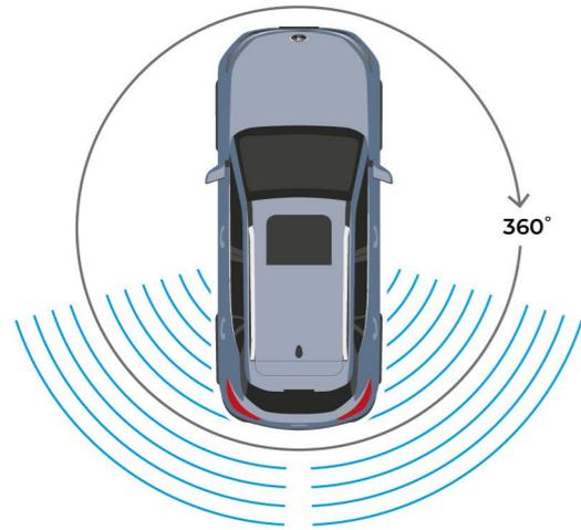
Москвич Ze оборудован камерой заднего вида и задними парктрониками — они помогут при парковке даже на самых узких улочках города. А система кругового обзора 360° поможет избежать аварийных ситуаций.
