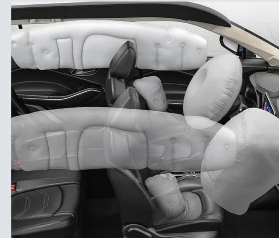
Электромобиль Москвич Ze оснащен 6 подушками безопасности для дополнительной защиты водителя и пассажиров.
