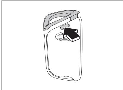
**Смарт-ключ:** Чтобы вынуть механический ключ, нажмите боковую кнопку и выньте ключ.
