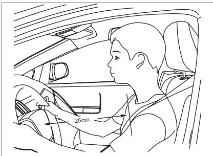
1. Отрегулируйте рулевое колесо: расстояние между рулевым колесом и грудью должно быть не менее 25 см.
