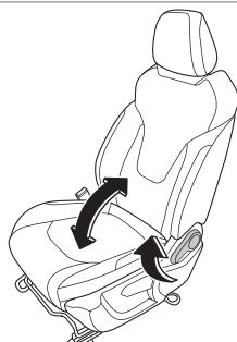
Ваш электромобиль оснащен ручным регулятором угла наклона спинки сиденья, расположенным снаружи сиденья.
