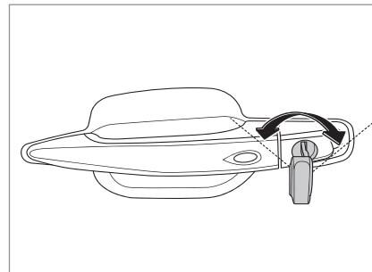
Поворотом против часовой стрелки ключа, вставленного снаружи в замок закрытой двери водителя, блокируются все двери электромобиля.
