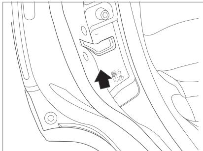
Если Вы хотите разблокировать дверь, сначала откройте дверь снаружи электромобиля и сдвиньте фиксатор на задней кромке двери в верхнее положение.
