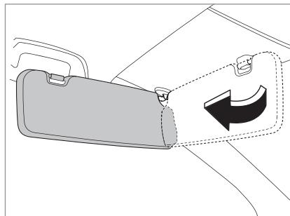
Чтобы защитить водителя и переднего пассажира от переднего и бокового солнечного света, перед водителем и передним пассажиром установлены два солнцезащитных козырька.
