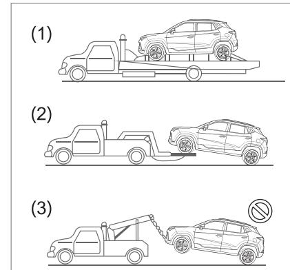
При необходимости буксировки электромобиля обратитесь в официальный дилерский центр послепродажного обслуживания «Москвич» или в специализированную компанию, занимающуюся транспортировкой автомобилей. Неправильные способы буксировки могут повредить электромобиль.
