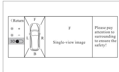
Когда экран разделен, панорамный вид отображается слева, а однокanalное видеоизображение / с правой стороны, можно нажать кнопку «2D/3D» для перехода к трехмерному изображению на левой стороне экрана, при этом на правой стороне сохранится одноканальное видеоизображение.
