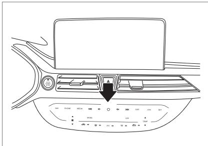
Кондиционеры могут нагревать, охлаждать и осушать воздух в электромобиле. Когда окна и раздвижной люк закрыты, кондиционеры работают с максимальной эффективностью. Вентиляция может ускорить охлаждение за счет циркуляции воздуха в салоне.
