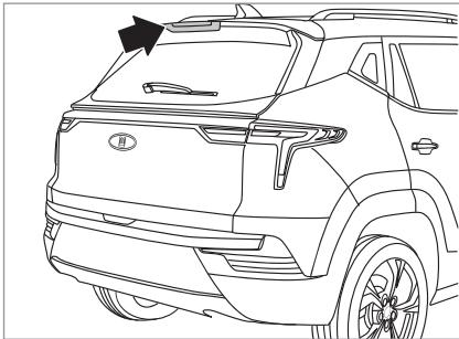
Верхний стоп-сигнал используется в дополнение к индикации других стоп-сигналов.
