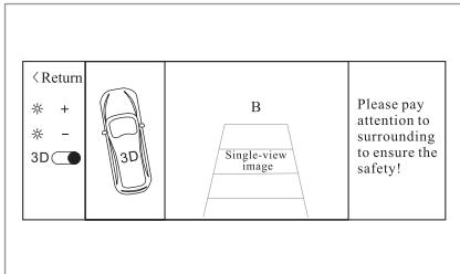
Когда селектор трансмиссии находится в положении задней передачи, передвиньте подрулевой переключатель в положение левого поворота для переключения экрана на panoramicный 3D дисплей левого вида и одноканальное видеоизображение заднего вида с дополнительным статическим ориентиром для движения назад. Когда задняя передача отключена, экран возвращается к предыдущему panoramicному изображению.
