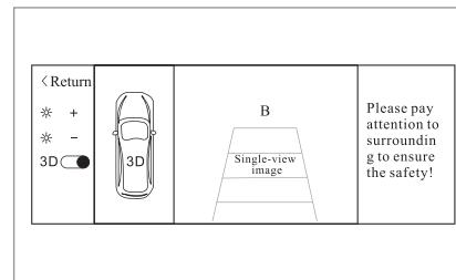
Когда на экране отображается трехмерный панорамный вид, переведите подрулевой переключатель в положение левого поворота для перехода к панорамному трехмерному изображению левого вида и одноканальному изображению с левой боковой камеры. Возврат подрулевого переключателя в исходное положение вернет изображение на экране к предыдущему виду.
