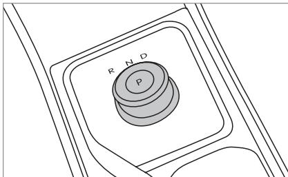
Электромобиль оснащён селектором выбора режимов с 4 положениями: «P» (стоянка), «R» (задний ход), «N» (нейтральное положение) и «D» (передний ход). Электромобиль может быть выключен в положениях Р / R / N / D и автоматически перейдет в режим «P» после выключения питания.
