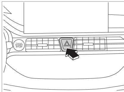
Выключатель аварийной сигнализации расположен под центральными вентиляционными отверстиями на приборной панели с треугольной меткой. Аварийная сигнализация может включаться даже после выключения питания электромобиля.
