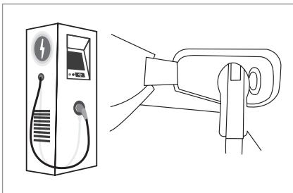
(3) Выньте вилку быстрой зарядки из гнезда быстрой зарядки, нажмите кнопку, затем медленно и вертикально вставьте в розетку быстрой зарядки электромобиля, а затем отпустите кнопку.
