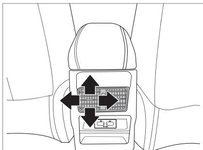
Перемещайте центральный регулятор каждого дефлектора вертикально и горизонтально, чтобы изменить направление воздушного потока.
