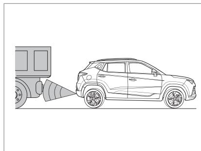
Датчик радара не может обнаружить автомобиль с высоким шасси.
