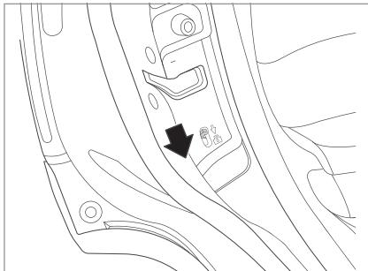
Для блокировки замка перед закрытием двери переместить фиксатор (см. рис.) в нижнее положение. В этом состоянии дверь можно открыть, только потянув за внешнюю ручку снаружи двери.
