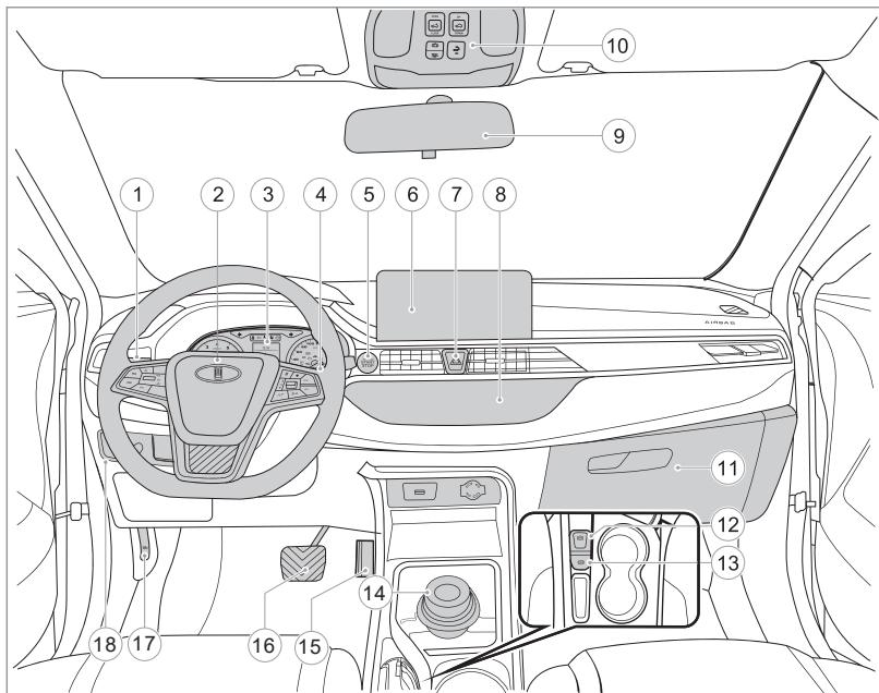
1. Подрулевой переключатель наружного освещения
