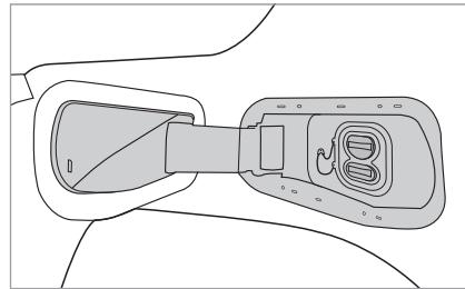
Зарядный разъем находится на переднем левом крыле кузова электромобиля. Когда электромобиль разблокирован, нажмите на правый край крышки зарядного разъема, Вы услышите легкий щелчок, крышка зарядного порта автоматически откроется.
