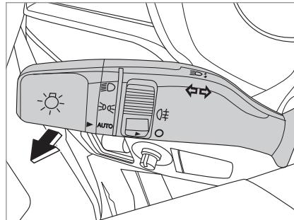
Чтобы включить дальний свет кратковременно, осторожно потяните рычаг переключателя к себе и отпустите его. При этом кратковременно загорается и затем гаснет дальний свет фар. Даже если рычаг переключателя находится в выключенном положении, дальним светом можно мигать. Дальний свет будет гореть до тех пор, пока Вы будете удерживать рычаг переключателя.
