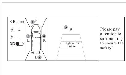
Когда экран разделен, панорамное изображение экран находится слева, а одноканальное видеоизображение / с правой стороны, можно нажать на участок 1 (F) для включения вида с передней камеры (F)..
