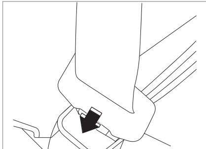
Нажмите кнопку разблокировки в кольце пряжки, чтобы отстегнуть ремень безопасности. Когда ремень безопасности отстегивается, он автоматически втягивается в инерционную катушку. В противном случае проверьте наличие узлов и перекручивания ремня безопасности и повторите попытку.
