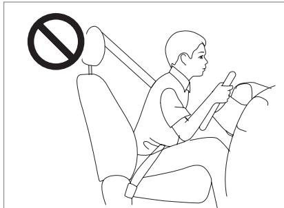
Чтобы снизить вероятность получения травм в результате аварии и обеспечить максимальную защиту, все пассажиры транспортного средства должны правильно располагаться на своих местах, при этом на переднем сиденье спинка водителя или пассажира должна плотно прилегать к поднятой в верхнее положение спинке сиденья по всей высоте. Если Вы будете находиться на заднем или переднем сиденье в наклонном положении, ремень безопасности не сработает должным образом.
