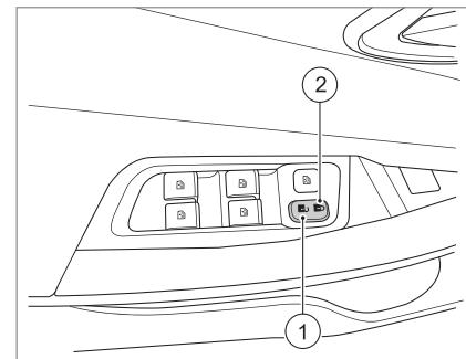
Кнопка управления замком двери со стороны водителя позволяет управлять замками четырех дверей. Нажмите переднюю часть кнопки управления (часть 2), четыре двери будут заблокированы; нажмите заднюю часть кнопки управления (часть 1), и четыре двери будут разблокированы.
