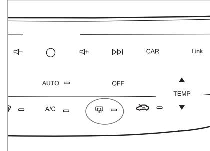
После включения питания переведите кнопку кондиционирования воздуха в режим обогрева. Функция обогрева наружных зеркал служит для устранения запотевания и размораживания наружных зеркал заднего вида.
