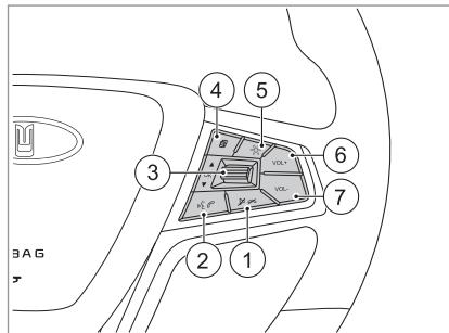
1. Данная функция доступна только для телефонов, оснащённых протоколом Bluetooth и системами распознавания голоса. При включенной системе управления голосом нажмите эту кнопку, чтобы выключить ее. Если телефон подключен по Bluetooth, а также во время разговора, нажмите эту кнопку, чтобы завершить или отклонить вызов. Нажмите эту кнопку, чтобы отключить звук во время работы мультимедийной системы.
