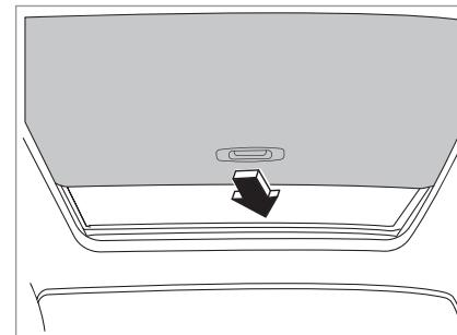
Шторку солнцезащитного козырька люка можно открывать и закрывать вручную. Когда люк открывается, шторка солнцезащитного козырька открывается автоматически. Закрывается шторка вручную.
