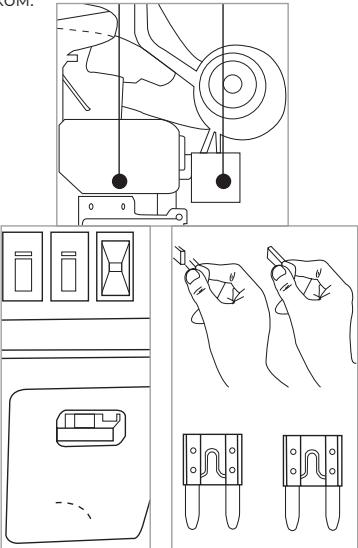
Если какое-либо электрическое оборудование не работает, проверьте соответствующий предохранитель в блоке предохранителей:
