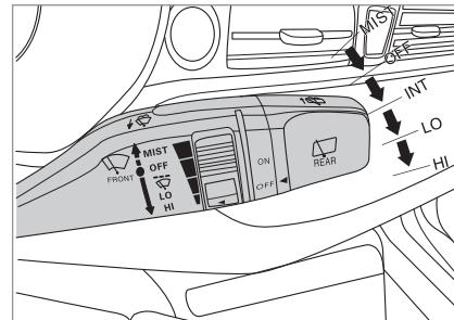
Правый подрулевой переключатель используется для управления стеклоочистителем и омывателем лобового стекла. Когда выключатель питания находится в положении ON, стеклоочиститель и омыватель находятся в рабочем состоянии.
