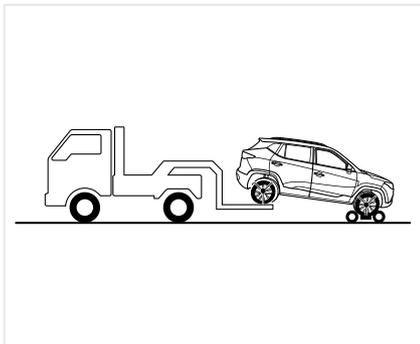
При погрузке только задних колес автомобиля требуется использование специальной тележки, на которой должны закрепляться передние колёса.
