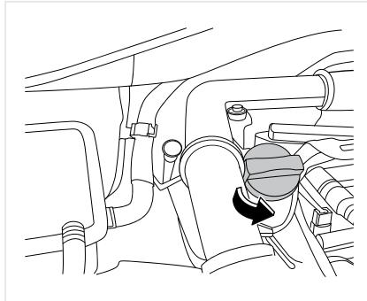
Если уровень моторного масла близок или ниже самой низкой отметки, моторное масло следует срочно долить. Его уровень ни при каких обстоятельствах не должен превышать верхнюю отметку на щупе. В противном случае масло будет попадать во впускной трубопровод двигателя через систему вентиляции картера и выбрасываться в атмосферу через выхлопную систему. Излишки моторного масла могут сгорать в катализитическом нейтрализаторе и повредить его.
