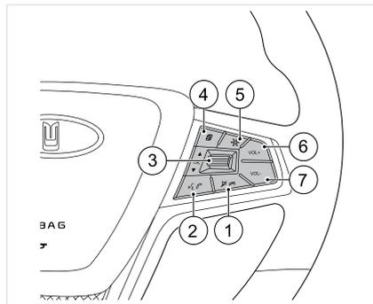
1. Эта функция доступна только для телефонов, оснащённых протоколом Bluetooth и системами распознавания голоса. При включённой системе управления голосом нажмите эту кнопку, чтобы выключить ее. Если телефон подключён по Bluetooth, а также во время разговора, нажмите эту кнопку, чтобы завершить или отклонить вызов. Нажмите эту кнопку, чтобы отключить звук во время работы мультимедийной системы.
