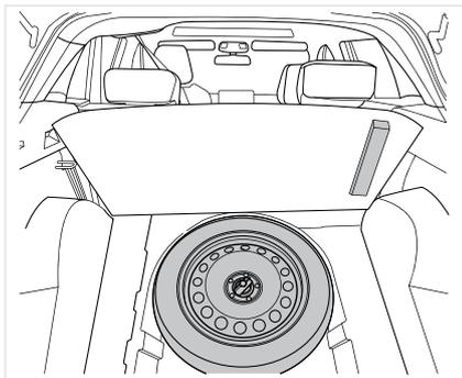
Запасное колесо закреплено в нижней части автомобиля под съёмным полом багажного отделения, буксировочная проушина и домкрат — под запасным колесом, а на задней части съёмного пола багажного отделения установлен треугольный знак аварийной остановки.
