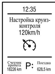
Скорость круиз-контроля отображает требуемую для автоматического поддержания скорость автомобиля, установленную водителем. Эта скорость может быть установлена переключателем системы. Если эта функция не активирована, на экране будет отображаться «--- км/ч».
