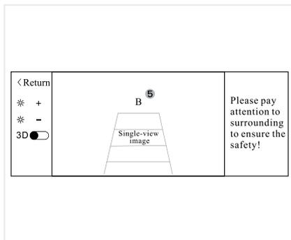
Когда интерфейс дисплея разделён, панорамный экран находится на левой стороне, а одноканальный видеодисплей — на правой, Вы можете переключить отображаемый экран в полноэкранный режим текущего одноканального видеодисплея, нажав область 5. Щёлкните область отображения видео в полноэкранный режим, он вернётся в режим разделения экрана.
