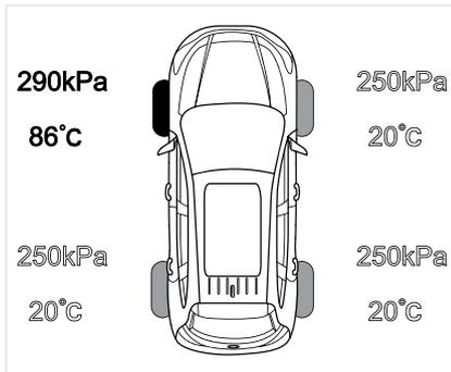
Состояние шины отображается на дисплее следующим образом. Белый цвет: если текущее давление в шинах примерно соответствует требуемому значению, оно отображается белым цветом. Красный цвет: если текущее давление в шинах больше или меньше указанного значения на более чем 57,5 кПа, показатель давления отображается красным
