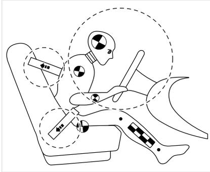
Пристегнув ремень безопасности, Вы замедлитесь вместе с автомобилем. Движение Вашего тела будет тормозиться ремнём безопасности, и ударное воздействие на тело снизится. Вот почему ремни безопасности так важны.
