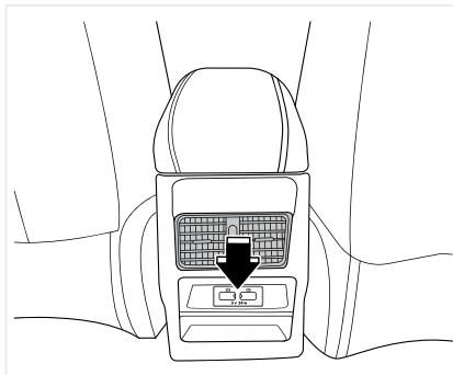
Ваш автомобиль оборудован USB-портами для зарядки мобильных устройств. USB-порты могут подавать питание, когда зажигание автомобиля включено. Откройте заглушку перед использованием USB-порта. Если вы не используете USB-порт, убедитесь, что заглушка USB-порта закрыта. Ваше мобильное устройство можно заряжать после того, как оно подключено к USB-порту по зарядному кабелю. Зарядный ток может автоматически регулироваться зарядным устройством и достигать 2,4 А.
