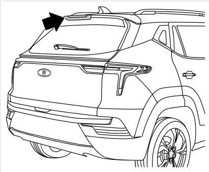
Верхний стоп-сигнал используется в качестве дополнительного к основным стоп-сигналам для обеспечения лучшей видимости и своевременности реакции водителей движущихся за вами транспортных средств на момент начала торможения вашего автомобиля.
