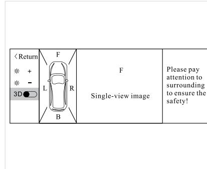
Когда интерфейс дисплея разделён, панорамный экран находится с левой стороны, а одноканальный видео-дисплей — на правой, Вы можете нажать кнопку 2D/3D, чтобы переключиться на экран 3D-дисплея: слева будет 3D-видеодисплей, а справа одноканальный видеодисплей.
