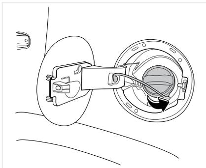
3. Медленно поверните пробку горловины топливного бака против часовой стрелки. Если Вы слышите шипение (звук выхода паров топлива), дождитесь, пока звук прекратится, затем отвинтите пробку и поместите её на кронштейн внутри крышки лючка горловины топливного бака.
