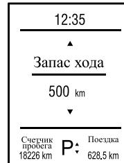
Этот расчётный показатель определяется по измеренной величине уровня топлива и среднему расходу топлива на данный момент времени. Система рассчитывает запас хода каждую секунду, а интерфейс обновляется каждые 10 секунд.
