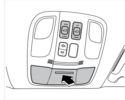
Футляр для очков расположен в передней части передней потолочной консоли. Нажмите на крышку футляра, чтобы его открыть. Поместите очки в футляр и закройте крышку, слегка надавив на нее.
