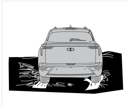
При движении по снегу используйте зимние шины, когда это возможно. Если Вы используете зимние шины, выберите тот же размер и модель, что и у оригинальных. При движении по снегу очень опасны высокая скорость, резкое ускорение, экстренное торможение и резкий поворот. Необходимо использовать по максимуму торможение двигателем во время замедления.
