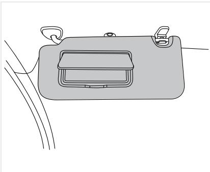
Чтобы защитить водителя и переднего пассажира от переднего и бокового солнечного света, в передней части потолка для водителя и пассажира оборудованы два солнцезащитных козырька.
