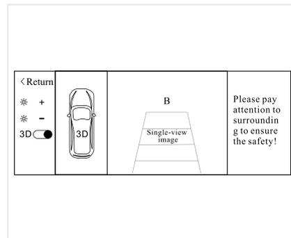
Когда отображается панорамный дисплей 3D и рычаг переключения (селектор) передач перемещается на заднюю передачу, экран переключается на панорамный дисплей 3D заднего вида и одноканальное заднее видеоизображение, плюс статическую вспомогательную линию для движения задним ходом. Когда передача заднего хода отключается, экран возвращается к предыдущему трёхмерному панорамному изображению.
