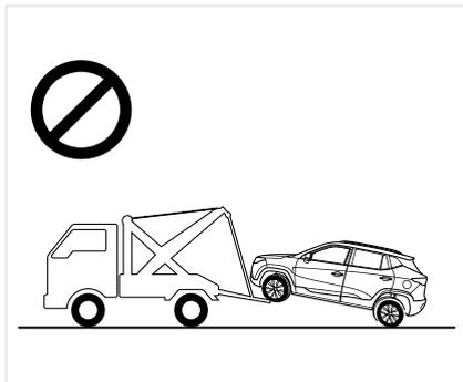
Запрещается использовать подъёмную тележку погрузчика для буксировки, иначе можно повредить кузов.
