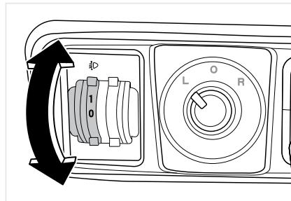
Дальность и направление ближнего света можно отрегулировать с места водителя. Переключатель регулировки расположен на панели переключателей на передней панели с левой стороны рулевого колеса. Расстояние освещения ближнего света можно отрегулировать, используя переключатель. Это позволяет учесть изменившееся положение кузова автомобиля, вызванное разной загрузкой последнего автомобиля. По мере увеличения угла поворота переключателя дальность освещения ближнего света уменьшается.
