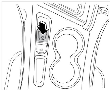
**Ручное затормаживание:** когда замок зажигания находится в положении ON, нажмите один раз выключатель EPB, произойдет стояночное затормаживание. На щитке приборов загорится красный индикатор парковки.
