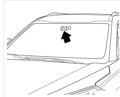
Окошко под VIN автомобиля может располагаться горизонтально по центру и вертикально в верхней части лобового стекла.
