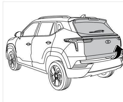
При необходимости открыть дверь багажного отделения изнутри (например, в экстренной ситуации или при отсутствии электропитания), откиньте крышку механизма аварийного открытия в нижней средней части двери багажного отделения, затем поверните кнопку аварийного открытия замка в направлении стрелки, чтобы открыть дверь багажного отделения.
