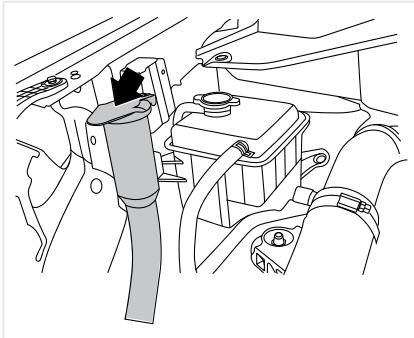
Откройте крышку бачка для стеклоомывающей жидкости (находится в моторном отсеке) для заполнения. Рекомендуется, чтобы уровень жидкости был выше половины после заполнения. В холодную погоду запрещено заправлять более трёх четвертей объема бачка. Стеклоомывающая жидкость замерзает и расширяется при низкой температуре. Если бачок переполнен, замерзающая жидкость не имеет пространства для расширения и может повредить бачок.
