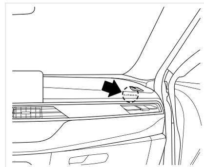
Ваш автомобиль оборудован системой пассивной безопасности (SRS) с надписью AIRBAG на крышке центрального клаксона на рулевом колесе и на передней панели перед пассажирским сиденьем. При столкновении, наряду с ремнями безопасности, система SRS обеспечивает защиту водителя и переднего пассажира.
