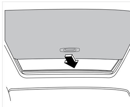
Шторку люка можно открывать и закрывать вручную. При открытии люка шторка открывается автоматически, но при закрытии люка шторку требуется закрыть вручную.
