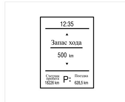
Этот расчётный показатель определяется по измеренной величине уровня топлива и среднему расходу топлива на данный момент времени. Система рассчитывает запас хода каждую секунду, а интерфейс обновляется каждые 10 секунд.
