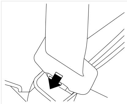
Нажмите кнопку фиксатора замка, чтобы отстегнуть ремень безопасности. Когда он отстёгнут, он автоматически втягивается в инерционную катушку. Если этого не происходит, проверьте, не перекручен ли ремень, и повторите попытку.
