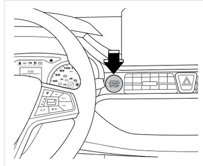
Возьмите смарт-ключ с собой в автомобиль, убедитесь, что рычаг переключения передач находится в положении N (для автомобиля с механической коробкой передач — МТ) или Р (для модели с автоматической — АКПП — или бесступенчатой трансмиссией — CVT). Не нажимайте на педаль сцепления (для модели МТ) или педали тормоза (для модели АКПП, CVT).
