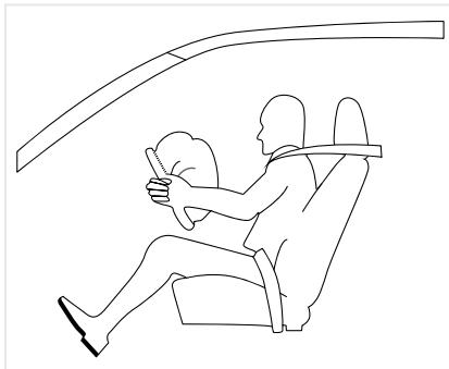
Когда компоненты управления SRS обнаруживают, что лобовое столкновение автомобиля достаточно сильное, они автоматически активируют подушки безопасности. Полностью надутые подушки и правильно пристёгнутые ремни безопасности замедляют движение пассажира и водителя, предотвращая серьёзные травмы головы. Подушка безопасности сдувается после раскрытия, освобождая пространство в салоне.
