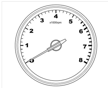
Тахометр показывает частоту вращения коленчатого вала (обороты) двигателя, измеряемую в об/мин. Двигатель более подвержен износу и потребляет больше топлива, если во время движения частота вращения коленчатого вала двигателя слишком высока. В большинстве случаев двигатели с низкими оборотами более экономичны.
