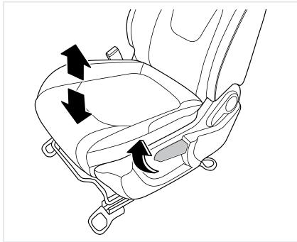
Водительское кресло имеет ручку регулировки высоты, которая находится сбоку от сиденья. Чтобы отрегулировать сиденье по высоте, переместите ручку регулировки высоты вверх или вниз и установите сиденье в желаемое положение.
