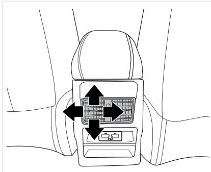
Переместите центральную управляющую клавишу каждого дефлектора по вертикали и горизонтали, чтобы изменить направление воздушного потока. Отрегулируйте клавишу слева направо, чтобы включить или выключить эту функцию.
