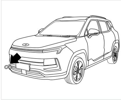
1. Снимите крышку гнезда крепления буксировочной проушины с помощью подходящего инструмента, например, плоской отвёртки. Вверните буксировочную проушину до упора и доверните с помощью подходящего инструмента.
