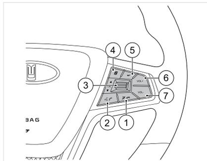
1. Эта функция доступна только для телефонов, оснащённых протоколом Bluetooth и системами распознавания голоса. При включенной системе управления голосом нажмите эту кнопку, чтобы выключить ее. Если телефон подключён по Bluetooth, а также во время разговора, нажмите эту кнопку, чтобы завер-
