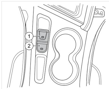
1. Выключатель стояночной тормозной системы (EPB).
