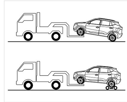
При погрузке передней оси задние колёса и подвеска должны быть в исправном состоянии. Стояночный тормоз должен быть отпущен, а автомобиль надёжно закреплен.
