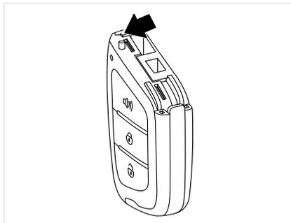
3. Снимите схемную плату.
