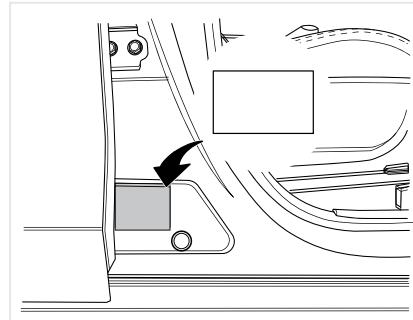
Идентификационная табличка автомобиля может располагаться в нижней части средней правой или левой стойки кузова и содержит следующую информацию: марка / идентификационный номер автомобиля / модель автомобиля / рабочий объём двигателя / модель двигателя / максимальная полезная мощность двигателя / максимально допустимый вес / количество пассажиров / заводской номер / дата изготовления.
