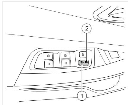
Кнопка управления дверным замком на стороне водителя позволяет управлять замками четырёх дверей. Нажмите переднюю часть кнопки управления (часть 2), четыре двери заблокируются; нажмите на заднюю часть кнопки управления (часть 1), и четыре двери разблокируются.
