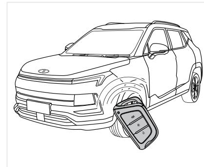
С пультом дистанционного управления на ключе некоторые функции могут быть реализованы без использования механического ключа, например, «блокировка», «разблокировка и поиск автомобиля», «разблокировка багажника» и т. д.
