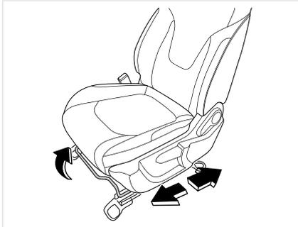
Потяните вверх и удерживайте рычаг фиксатора под передней частью сиденья, чтобы разблокировать сиденье. Сдвиньте сиденье в желаемое положение, затем отпустите рычаг фиксатора. Попробуйте переместить сиденье назад и вперед, чтобы убедиться, что сиденье зафиксировано на месте.
