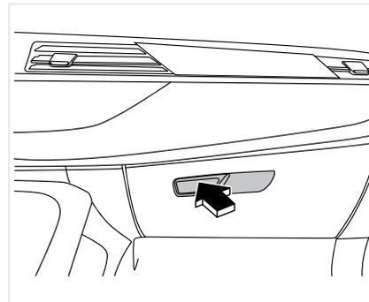
Потяните вверх ручку, показанную на рисунке, чтобы открыть перчаточный ящик. Нажмите на крышку ящика, чтобы закрыть его.
