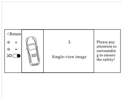
Когда отображается панорамный дисплей 3D, передвиньте рычаг подрулевого переключателя в положение включения сигнала левого поворота, чтобы перейти на панорамный дисплей 3D с левым обзором и одноканальное левое видеоизображение. Когда сигнал левого поворота пропадает, экран возвращается к предыдущему трёхмерному панорамному дисплею.
