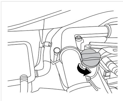
Если уровень моторного масла близок или ниже самой низкой отметки, моторное масло следует срочно долить. Его уровень ни при каких обстоятельствах не должен превышать верхнюю отметку на щупе. В противном случае масло будет попадать во впускной трубопровод двигателя через систему вентиляции картера и выбрасываться в атмосферу через выхлопную систему. Излишки моторного масла могут сгорать в каталитическом нейтрализаторе и повредить его.
