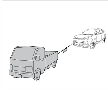
2. Закрепите буксирный трос. Прикрепите его к буксировочной проушине и будьте осторожны, не повредите кузов. Обозначьте трос яркой тканью (размером более 0,3 м x 0,3 м), привязав её к середине буксирного троса.
