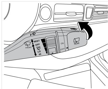
Поверните переключатель на торцевой части рычага по часовой стрелке в положение ON, чтобы включить задний стеклоочиститель.
