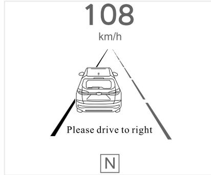
Интерфейс предупреждений на щитке приборов показан на рисунке выше (автомобиль отклоняется от левой полосы движения). Когда автомобиль без включенных указателей поворота отклоняется от полосы движения, обнаруженной системой, на щитке приборов отображается предупреждение и издаётся звуковой сигнал с частотой 2 раза в секунду.
