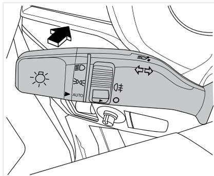
Поверните бочковидный переключатель на конце джойстика в положение **D** и сдвиньте джойстик вперёд (в направлении от водителя) до щелчка. Будет включён дальний свет фар. При включении дальнего света фар на щитке приборов загорится индикатор дальнего света. Если Вы хотите снова переключиться на ближний свет, оттяните джойстик назад (в направлении к водителю).
