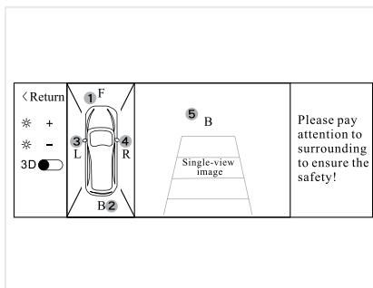
Когда интерфейс дисплея разделён, панорамный экран находится с левой стороны, а одноканальный видеодисплей — с правой, Вы можете нажать область 1, чтобы переключиться на изображение экрана переднего вида. Чтобы переключиться на задний вид, нажмите на область 2 или выберите R. Чтобы перейти к обзору вида слева, нажмите на область 3 или потяните левый поворотный переключатель (если не установлена задняя передача).
