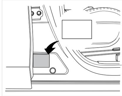
Идентификационная табличка автомобиля может располагаться в нижней части средней правой или левой стойки кузова и содержит следующую информацию: марка / идентификационный номер автомобиля / рабочий объём двигателя / модель двигателя / максимальная полезная мощность двигателя / максимально допустимый вес / количество пассажиров / заводской номер / дата изготовления.
