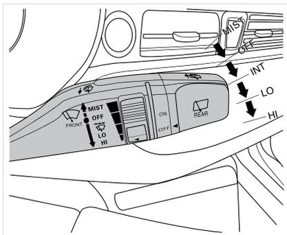
Джойстик используется для управления очистителем и омывателем лобового стекла.
