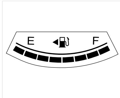
Указатель уровня топлива показывает оставшееся количество топлива в топливном баке. Верхний предел указателя обозначен как F, а нижний – как E. Когда замок зажигания находится в положении ON, указатель уровня топлива показывает количество топлива в топливном баке.
