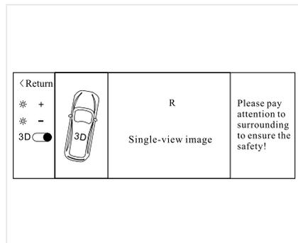
Когда отображается панорамный дисплей 3D, передвиньте рычаг подрулевого переключателя в положение включения сигнала правого поворота, чтобы перейти на панорамный дисплей 3D правого обзора и одноканальное правое видеоизображение. Когда сигнал правого поворота пропадает, экран возвращается к предыдущему трёхмерному панорамному дисплею.
