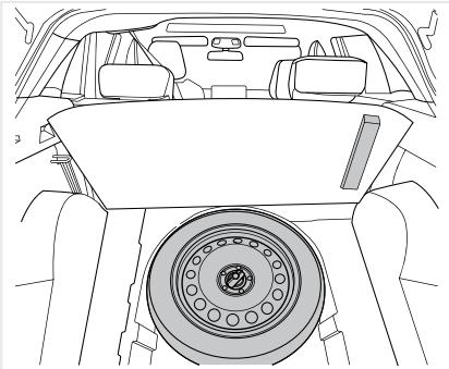
Запасное колесо закреплено в нижней части автомобиля под съёмным полом багажного отделения, буксировочная проушина и домкрат — под запасным колесом, а на задней части съёмного пола багажного отделения установлен трёхугольный знак аварийной остановки.
