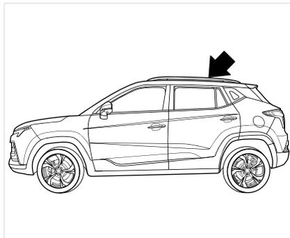
Если Ваш автомобиль оборудован багажными рейлингами на крыше, у Вас есть возможность перевозить грузы на крыше, предварительно надёжно и безопасно закрепив их на рейлингах.
