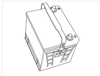
Ваш автомобиль оснащён необслуживаемой аккумуляторной батареей. Если необходимо заменить её на новую, её каталожный номер должен совпадать с номером на этикетке штатной батареи. Обратитесь к разделу «Обзор подкапотного пространства», чтобы определить, где находится аккумуляторная батарея.
