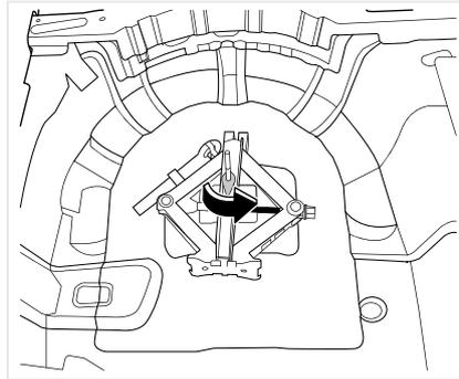
6. При подъёме автомобиля домкратом, чтобы предотвратить его скатывание, необходимо привести в действие стояночный тормоз, а также подложить противооткатный упор под колесо, расположенное диагонально по отношению к заменяемому колесу.
