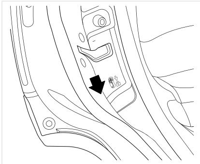
Чтобы предотвратить открытие задней двери изнутри, фиксатор необходимо установить в нижнее положение перед закрытием двери. При этом условии дверь можно открыть, только потянув за внешнюю ручку снаружи двери.
