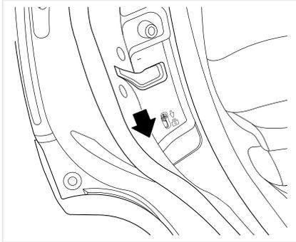
Чтобы предотвратить открытие задней двери изнутри, фиксатор
