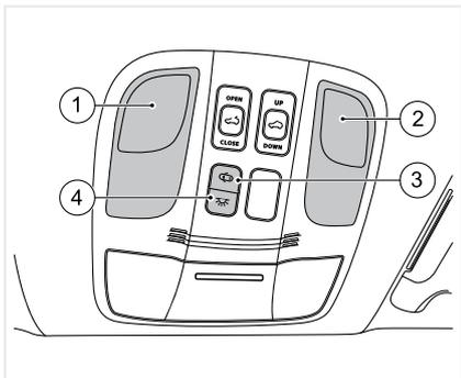
1. Выключатель левой лампы для чтения. Нажмите, чтобы включить или выключить левую лампу для чтения.
