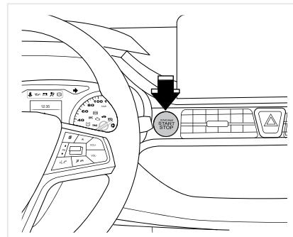
Возмите смарт-ключ с собой в автомобиль, убедитесь, что рычаг переключения передач находится в положении N (для автомобиля с механической коробкой передач — MT) или P (для модели с автоматической — АКПП — или бесступенчатой трансмиссией — CVT). Не нажимайте на педаль сцепления (для модели MT) или педали тормоза (для модели АКПП, CVT).
