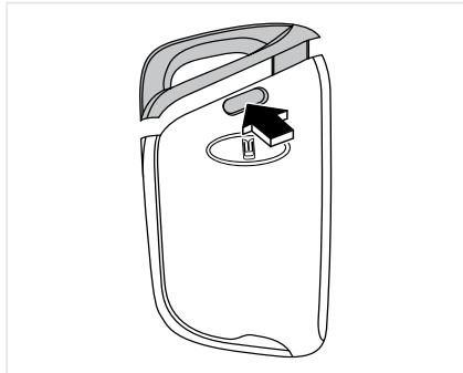
2. Вставьте прямую отвертку в отверстие для демонтажа, чтобы приподнять верхний кожух, а затем разъедините части корпуса.
