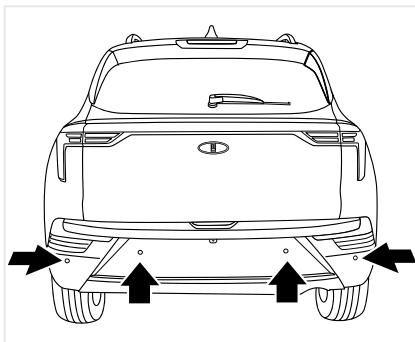
Радар заднего хода основан на принципе ультразвукового измерения расстояния от радарного датчика до препятствия в непосредственной близости позади автомобиля.
