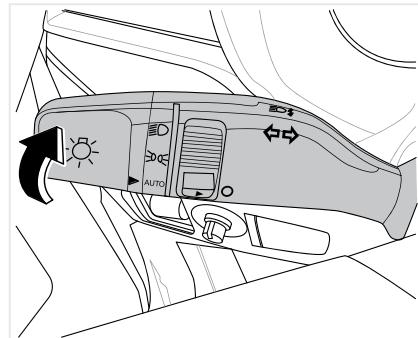
Когда бочковидный переключатель повернут в положение , включено габаритное освещение, фонарь освещения номерного знака, подсветка щитка приборов и центральной консоли управления. Ближний свет включается поворотом переключателя в положение .
