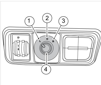
1. Выберите это положение переключателя, чтобы отрегулировать положение левого наружного зеркала заднего вида.
