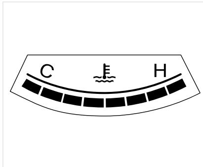
Этот прибор показывает температуру охлаждающей жидкости двигателя при включении зажигания. Верхний предел температуры обозначен как H, а нижний предел обозначен как С. Когда кнопка зажигания и пуска Start/Stop находится в положении ON, указатель показывает температуру охлаждающей жидкости двигателя посредством восьми высевающих прямоугольных индикаторов.
