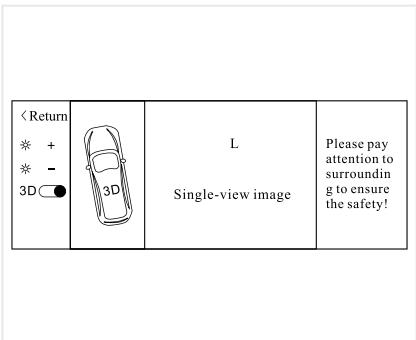
Когда отображается панорамный дисплей 3D, передвигните рычаг подрулевого переключателя в положение включения сигнала левого поворота, чтобы перейти на панорамный дисплей 3D с левым обзором и одноканальное левое видеоизображение. Когда сигнал левого поворота пропадает, экран возвращается к предыдущему трёхмерному панорамному дисплею.
