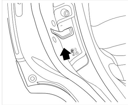
Если Вы хотите разблокировать замок безопасности, откройте дверь снаружи автомобиля и установите фиксатор блокировочного устройства для безопасности детей в верхнее положение.
