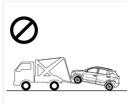
Запрещается использовать подъемную тележку погрузчика для буксировки, иначе можно повредить кузов.
