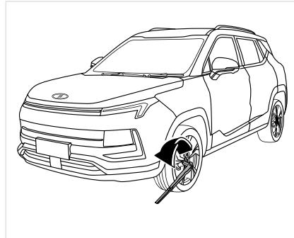
10. Установите домкрат на плоскую и надёжную поверхность. Поверните верхнюю часть домкрата по часовой стрелке, чтобы отрегулировать его высоту, как показано на рисунке.
