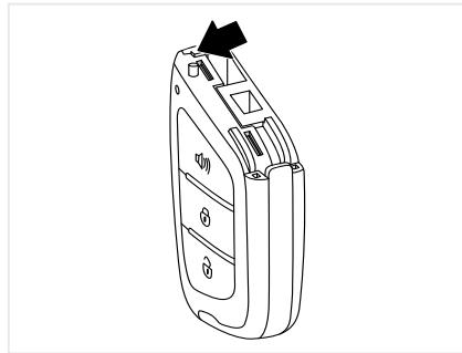
3. Снимите схемную плату.
