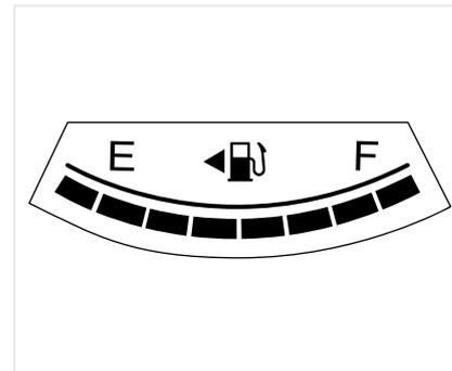
Указатель уровня топлива показывает оставшееся количество топлива в топливном баке. Верхний предел указателя обозначен как F, а нижний – как E.
