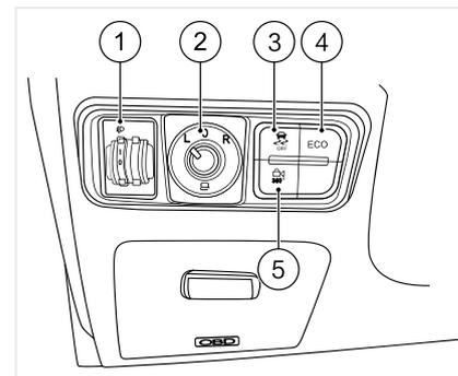
1. Переключатель регулировки высоты света фар. После включения фар высоту света фар можно отрегулировать вращением переключателя регулировки фар. Он имеет 6 положений, чтобы точно отрегулировать высоту света.
