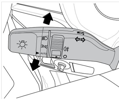
Если Вам необходимо повернуть налево, нажмите на левый подрулевой переключатель сверху вниз; если нужно повернуть направо, нажмите на левый подрулевой переключатель снизу вверх. Соответствующий индикатор поворота будет мигать на щитке приборов. После поворота и возвращения рулевого колеса назад в исходное положение джойстик указателя поворота также возвращается в исходное положение, индикатор автоматически гаснет.
