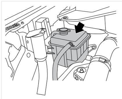
Запрещается использовать охлаждающую жидкость с концентрацией более 60 % или менее 35 %. Иначе можно повредить систему охлаждения двигателя. При добавлении или замене охлаждающей жидкости выбирайте подходящую концентрацию в соответствии со следующей таблицей:
