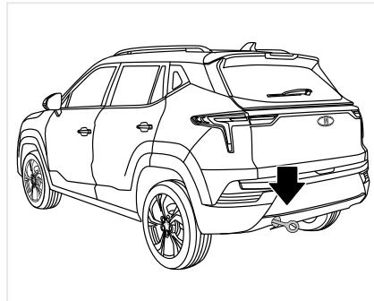
1. Закрепите буксировочную проушину в предназначенном для неё месте (см. рис.).
