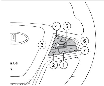
1. Эта функция доступна только для телефонов, оснащённых протоколом Bluetooth и системами распознавания голоса. При включённой системе управления голосом нажмите эту кнопку, чтобы выключить ее. Если телефон подключен по Bluetooth, а также во время разговора, нажмите эту кнопку, чтобы завершить или отклонить вызов. Нажмите эту кнопку, чтобы отключить звук во время работы мультимедийной системы.
