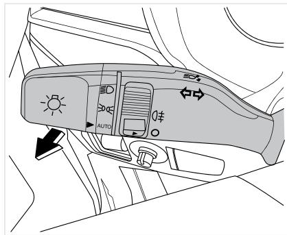
Поверните бочковидный переключатель на конце джойстика в положение и сдвиньте джойстик вперёд (в направлении от водителя) до щелчка. Будет включён дальний свет фар. При включении дальнего света фар на щитке приборов загорится индикатор дальнего света. Если Вы хотите снова переключиться на ближний свет, оттяните джойстик назад (в направлении к водителю).
