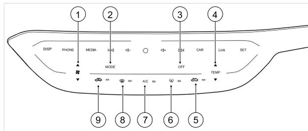
1. Кнопки регулировки интенсивности работы вентилятора: нажмите верхнюю кнопку, чтобы увеличить объём воздуха; нажмите нижнюю кнопку, чтобы уменьшить объём воздуха.
