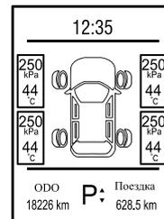
Интерфейс монитора давления воздуха/ температуры в шинах может контролировать давление и температуру в шинах. Единица измерения давления в шинах — кПа, точность — 1 кПа. При получении недопустимого значения экран будет мигать с частотой 1 Гц с отображением знака «-,-». Единица измерения температуры шины — °C, точность — 1 °C. При получении недопустимого значения экран будет мигать с частотой 1 Гц, на экране будет отображаться знак «-».
