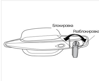
Когда дверь запирается на ключ снаружи автомобиля, четыре двери блокируются поворотом его против часовой стрелки. При отпирании поверните ключ по часовой стрелке, затем потяните ручку двери наружу, чтобы открыть дверь.
