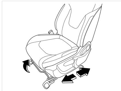
Потяните вверх и удерживайте рычаг фиксатора под передней частью сиденья, чтобы разблокировать сиденье. Сдвиньте сиденье в желаемое положение, затем отпустите рычаг фиксатора. Попробуйте переместить сиденье назад и вперед, чтобы убедиться, что сиденье зафиксировано на месте.
