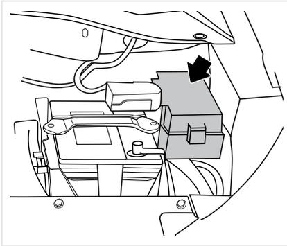
Каждая электрическая цепь оснащена предохранителем для предотвращения повреждения цепи вследствие короткого замыкания или перегрузки. Если новый предохранитель перегорит после замены через короткое время, это означает, что цепь неисправна. Обратитесь в официальный дилерский центр «Москвич», чтобы проверить и найти причину, а также отремонтировать систему и заменить предохранитель. При самостоятельной замене используйте предохранитель той же мощности.
