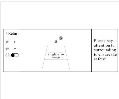
Когда интерфейс дисплея разделён, панорамный экран находится на левой стороне, а одноканальный видео-дисплей — на правой, Вы можете переключить отображаемый экран в полноэкранный режим текущего одноканального видео-дисплея, нажав область 5. Щёлкните область отображения видео в полноэкранном режиме, он вернётся в режим разделения экрана.
