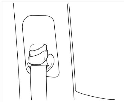
Вы можете отрегулировать положения верхних точек крепления ремней безопасности сиденья водителя и переднего пассажира. Положение точки крепления по высоте регулируется по гнезду фиксации.
