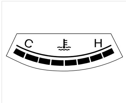
Этот прибор показывает температуру охлаждающей жидкости двигателя при включении зажигания. Верхний предел температуры обозначен как H, а нижний предел обозначен как C. Когда кнопка зажигания и пуска Start/Stop находится в положении ON, указатель показывает температуру охлаждающей жидкости двигателя посредством восьми высвечивающихся прямоугольных индикаторов.
