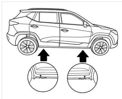
При использовании домкрата для подъёма автомобиля проверьте его положение несколько раз, чтобы предотвратить падение автомобиля.
