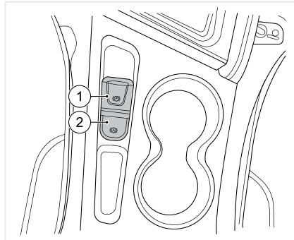
1. Выключатель стояночной тормозной системы (EPB).
