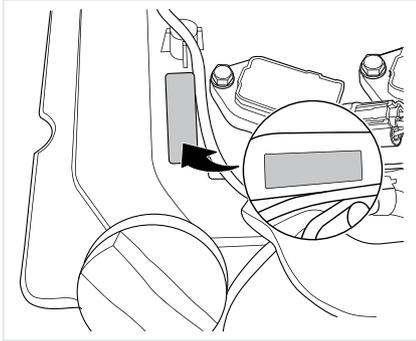
Штамп с серийным номером двигателя находится на верхней стороне крышки двигателя.
