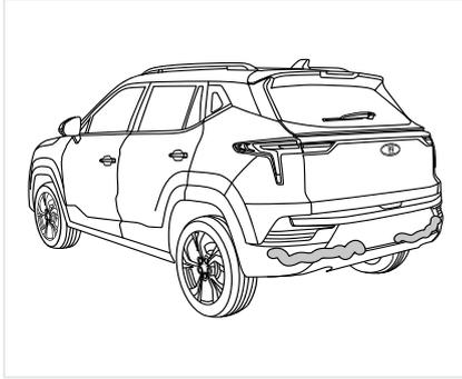
Если датчик радара заднего хода заморожен, в системе радара заднего хода может быть неисправен сигнал тревоги. Если автомобиль движется по крутому уклону, может возникнуть сбой в работе радарной системы заднего хода.
