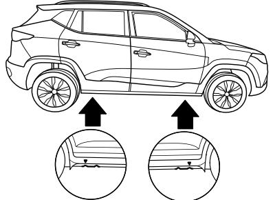
При использовании домкрата для подъёма автомобиля проверьте его положение несколько раз, чтобы предотвратить падение автомобиля.
