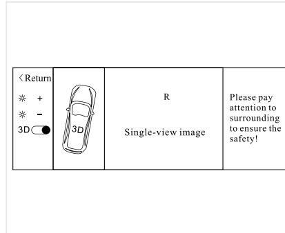
Когда отображается панорамный дисплей 3D, передвигните рычаг подрулевого переключателя в положение включения сигнала правого поворота, чтобы перейти на панорамный дисплей 3D правого обзора и одноканальное правое видеоизображение. Когда сигнал правого поворота пропадает, экран возвращается к предыдущему трёхмерному панорамному дисплею.
