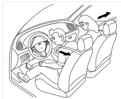
Некоторые модели оснащены преднатяжителями ремней безопасности для сидений водителя и переднего пассажира. Это устройство призвано обезопасить водителя и переднего пассажира в случае лобового удара определенной силы. Преднатяжитель ремня может работать одновременно с подушкой безопасности.
