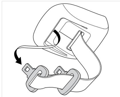
Трёхточечный ремень безопасности среднего места заднего сиденья находится в корпусе инерционной катушки на потолке автомобиля.
