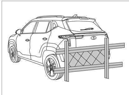
Ультразвуковая система не может обнаружить железную проволоку, кабель, металлическую сетку и прочие подобные объекты.
