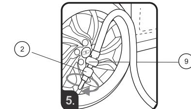
6. Снимите защитный колпачок на конце надувного шланга и завинтите шланг **②** на вентиль шины так, чтобы клапан для сброса давления **⑨** был закреплен.
