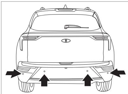
В задний бампер электромобиля встроены ультразвуковые датчики обнаружения препятствий при движении задним ходом, которые излучают и принимают отраженные от препятствий сигналы, по которым система определяет наличие и расстояние до каждого обнаруженного препятствия.
