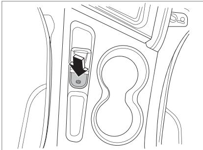
Когда функция автоматического удержания активирована, то после остановки электромобиля не требуется удерживать нажатой педаль тормоза, а электромобиль продолжает оставаться заторможенным.
