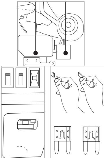
Если какое-либо электрическое оборудование не работает, проверьте соответствующий предохранитель в блоке предохранителей:
