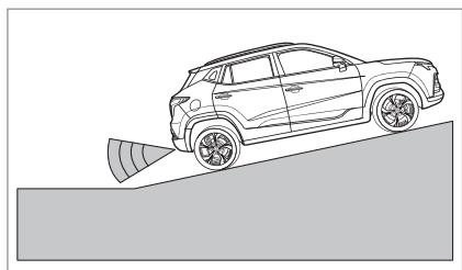
Система также может подать ошибочный сигнал при движении на уклоне.
