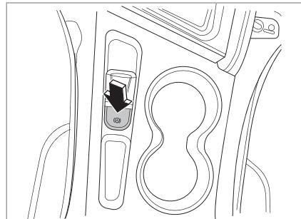
При парковке потяните рычаг выключателя стояночного тормоза, загорится индикатор (1). Для растормаживания нажмите переключатель питания электромобиля, установив его в положение ON. Удерживая педаль тормоза, нажмите рычаг выключателя стояночного тормоза. Контрольные индикаторы и индикатор состояния парковки (1) на щитке приборов гаснут, указывая на то, что электромобиль расторможен.
