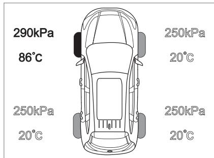
Обозначения шин и рамки дисплея в интерфейсе дисплея отображаются следующим образом:
