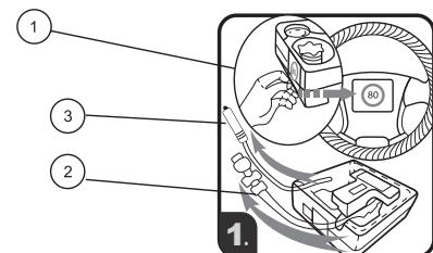
2. Вытяните шланг для накачивания ② и штекер питания ③ в корпусе компрессора.
