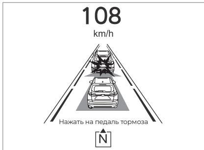
Возможны два уровня предупреждений: предупреждение первого уровня (общего типа), предупреждение второго уровня (усиленного типа).
