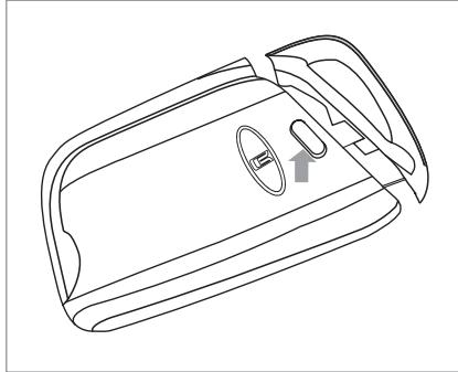
2. Расфиксируйте и разъедините половины корпуса пульта (см. рис.).
