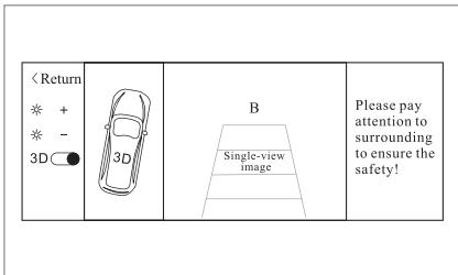
Когда селектор трансмиссии находится в положении задней изображению передачи, передвиньте подрулевой переключатель в положение правого поворота для переключения экрана на panoramicный 3D дисплей правого вида и одноканальное видеоизображение заднего вида с дополнительным статическим ориентиром для движения назад. Когда задняя передача отключена, экран возвращается к предыдущему panoramicному.
