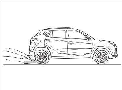
При движении в снег или дождь система также может допустить ошибку сигнализации.
