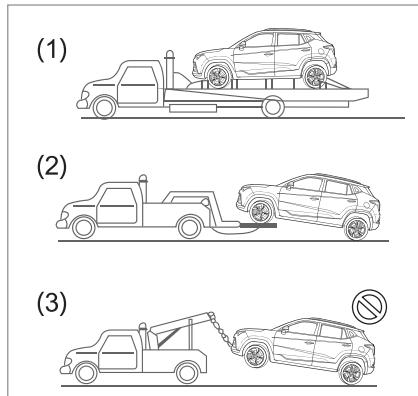
При необходимости буксировки электромобиля обратитесь в авторизованный центр «Москвич» или в специализированную компанию, занимающуюся транспортировкой автомобилей. Неправильные способы буксировки могут повредить электромобиль.
