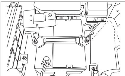
Электромобиль оснащён не требующей технического обслуживания свинцово-кислотной батареей 12 В. Если Вам необходимо её заменить, пожалуйста, убедитесь в соответствии характеристик свинцово-кислотных батарей.
