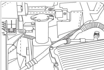
Регулярно проверяйте уровень жидкости для стеклоомывателя и своевременно добавляйте ее. В холодных условиях моющий раствор замерзает и набухает, повреждая резервуар для омывающей жидкости. Запрещается добавлять жидкость для омывателя более чем на три четверти объема.
