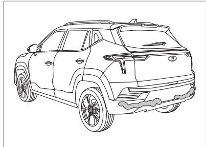
Если ультразвуковой датчик замерз, система может выдать ошибочный сигнал.
