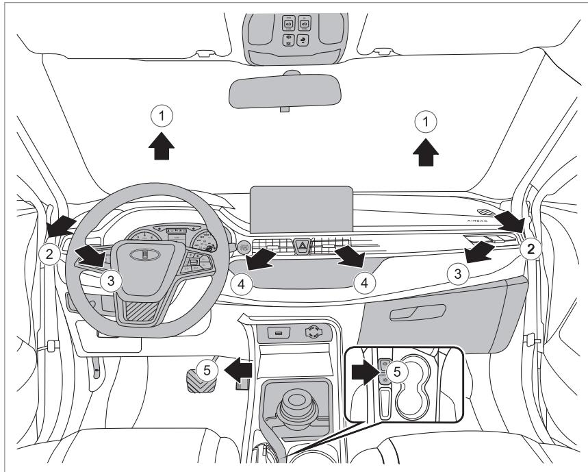
1. Выпуклое отверстие для размораживания / устранения запотевания лобового стекла
