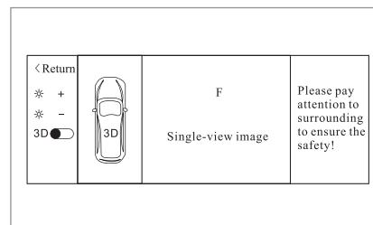
Когда экран разделен, панорамный вид отображается слева, а однокanalное видеоизображение / с правой стороны, можно нажать кнопку «2D/3D» для перехода к трехмерному изображению на левой стороне экрана, при этом на правой стороне сохранится однокanalное видеоизображение.
