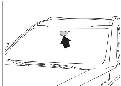
VIN-окно электромобиля расположено горизонтально в центре и вертикально в верхней части лобового стекла.
