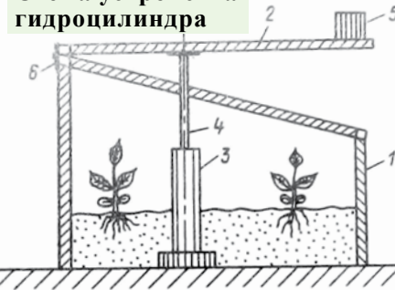
Схема устройства гидроцилиндра
