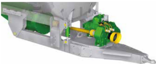
Механический привод через коробку двух насосов
