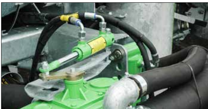
Гидравлическое управление реверсом насоса
