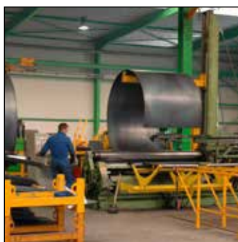
Сгибание стальных листов (центровочный станок с ЧПУ)
