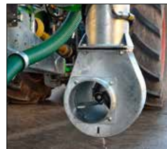
Погружной турбонагнетатель на насосном рукаве
