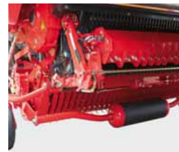
Дополнительный ролик копирующего колеса для подборщика
