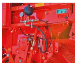
Гидравлическое снятие нагрузки с подборщика
