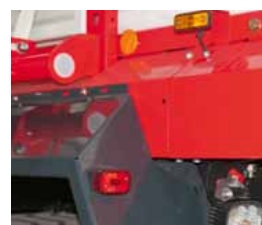
Фонари контурного освещения и габаритные фонари
