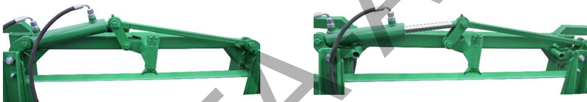
Рис. 7. Замок штанги закрыт (слева), замок штанги открыт (справа).
