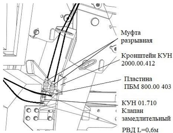
Рисунок 20 – Подсоединение гидросистемы погрузчика к гидросистеме трактора
