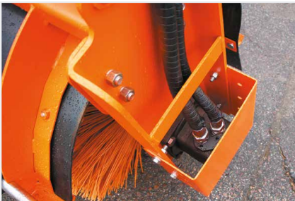
Гидромотор закрыт защитным кожухом
