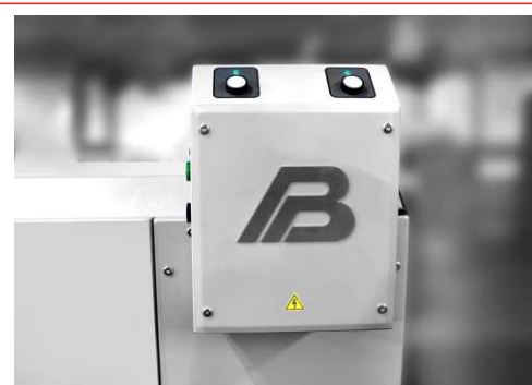
Пульт управления из комплекта привода дежеопрокидывателя «ВОСХОД-ДО-12У»
