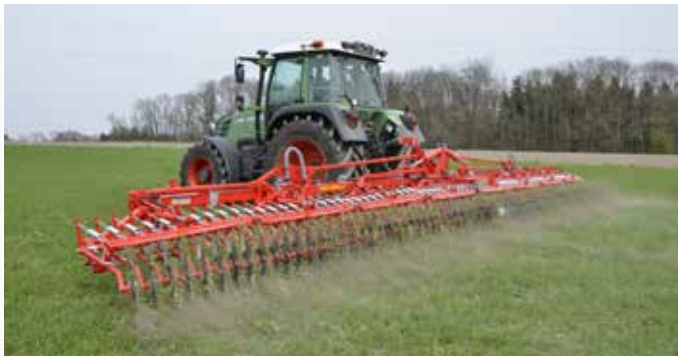
Striegeldurchgang im Frühjahr mit dem Rollstriegel
