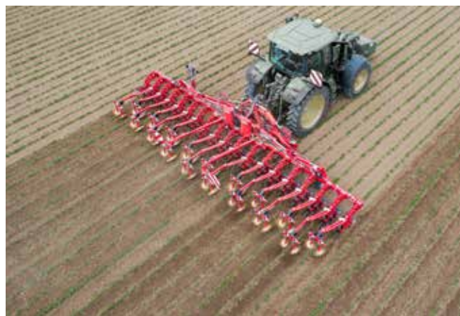
Hacken im Heck mit Kameralenkung und Paketklappung
