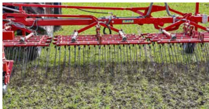
Striegeldurchgang im Frühjahr mit einem Zinkenstriegel
