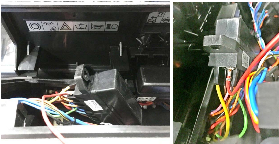
Рис. 4.3.24 – Подключение жгута кабины к питанию
