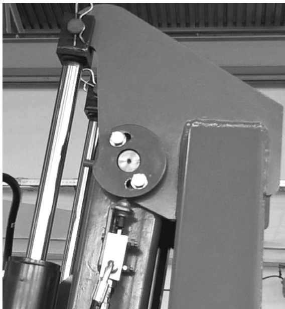
Рис. 6.1.1. Верхний кулачок системы подъёма задних колёс.
