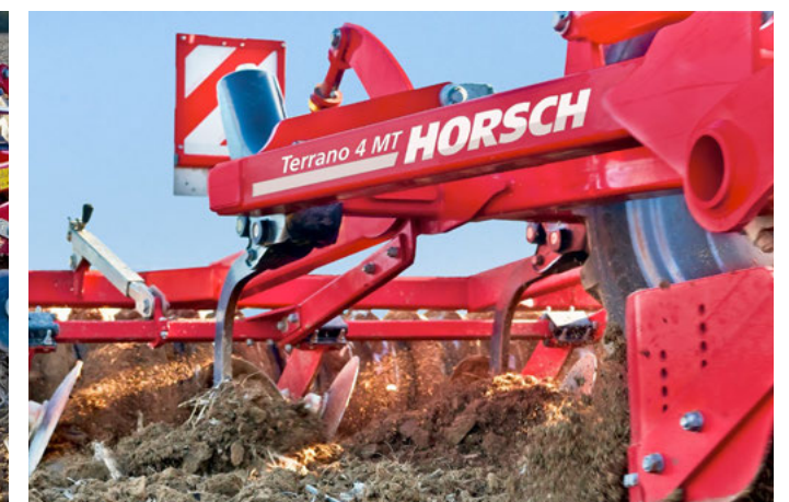
Tiefes Lockern und minimales Mischen durch LD Schare
