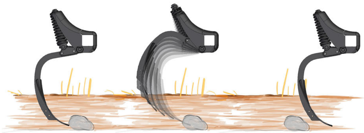
TerraGrip II – Auslösewirkung
