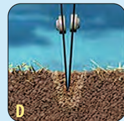
Д. Сошники із подеійними дисками працюють по вже обробленій смужці та розміщують насіння на дно борозни
