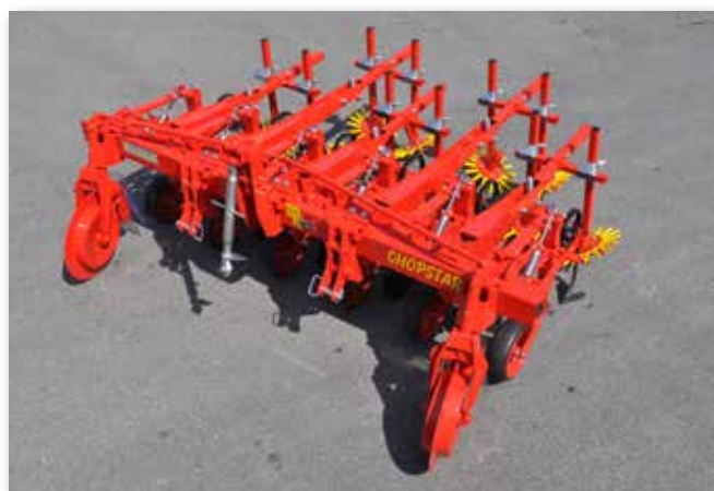
Binage arrière avec pilotage par 3e point
