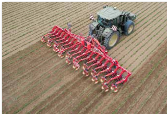
Binage arrière avec guidage par caméra en repliage en portefeuille
