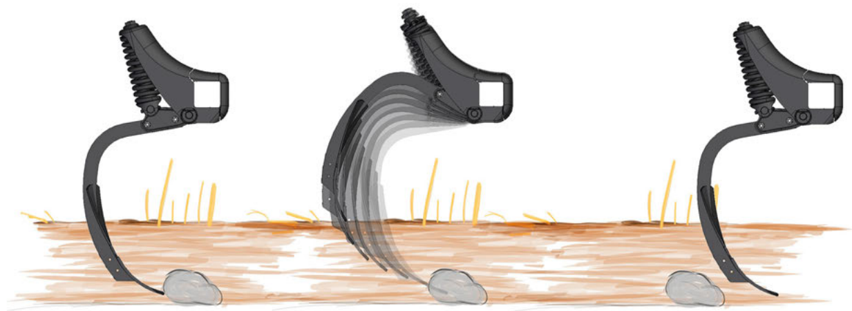
Механізм спрацювання системи захисту TerraGrip II
