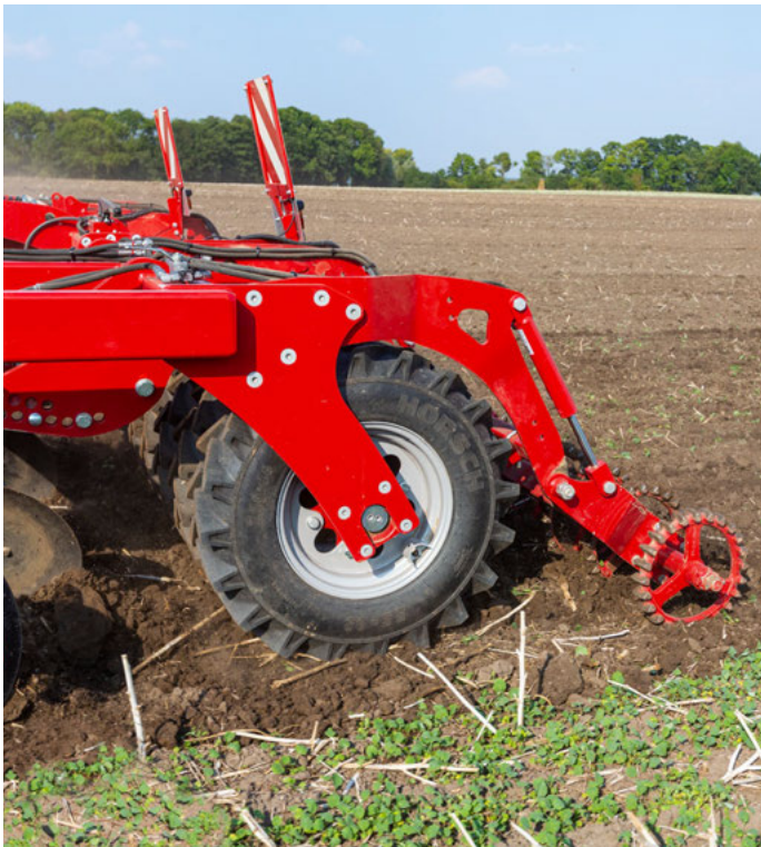
Коток TopRing для ефективного ущільнення між колесами колісного котка
