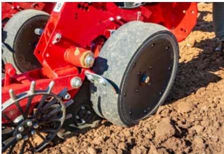
Standardowe koło prowadzące na głębokości w normalnych warunkach
