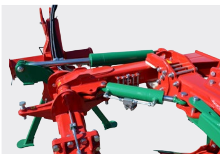
Schnittbreiteneinstellung am 1. Pflugkörper ArcoAgro
