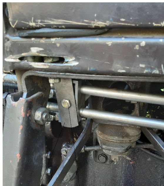
Опора трубопровода Прижим Болт М8х50 Гайка М8
