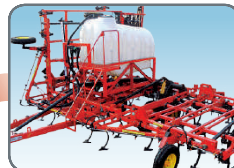
Комплекс для внесення рідких добрив до: КПС-7ПМ, КПС-9ПМ, КПС-12ПМ
