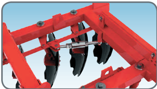
Регулювання кута атаки дисків
