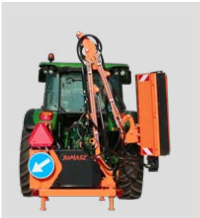
Позиция для транспортировки - рабочий орган не заслоняет задний бампер с фарами.
