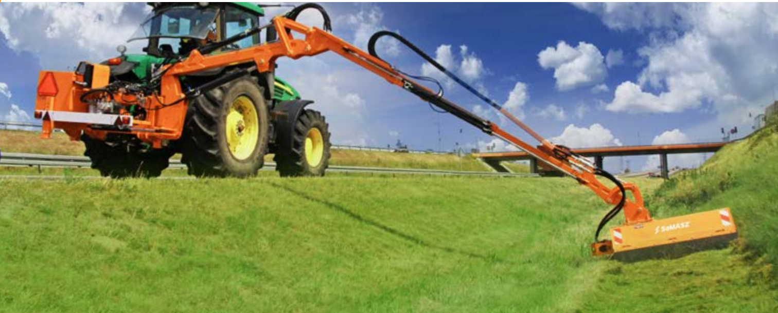
Радиус действия стрелы CAMEL 900 со скашивающей головкой LAMA 120 [см]
