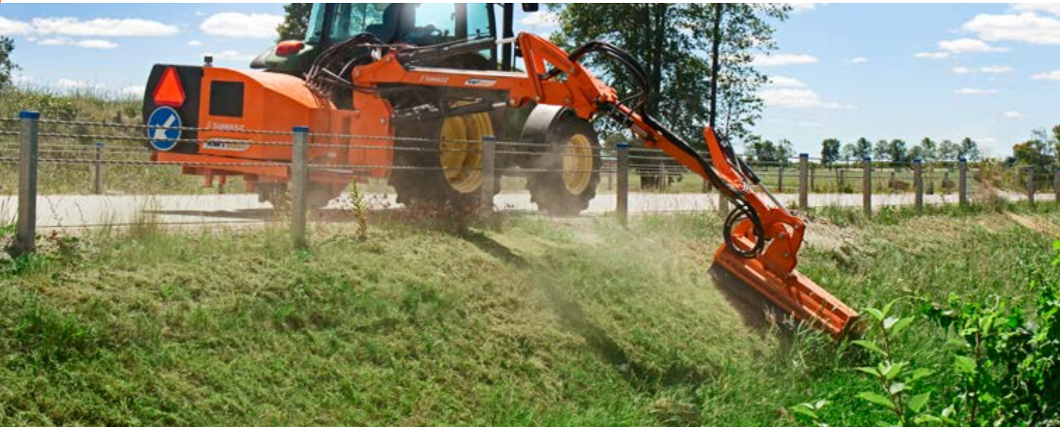
Радиус действия гидравлического плеча KWT 651E со скашивающей головкой типа LAMA 121
