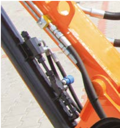
Гидравлический ригель на главном цилиндре вместе с регулируемым дроссельным клапаном.
