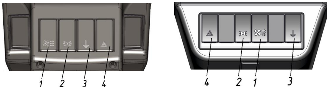
1 – клавиша включения отопителя кабины; 2 – клавиша включения габаритных огней, фар головного освещения; 3 – клавиша включения «массы» трактора; 4 – клавиша включения аварийной сигнализации
