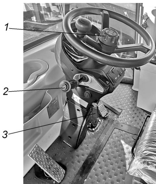
1 - гайка-барашек регулировки рулевого колеса по высоте; 2 – подрулевой переключатель; 3 - рукоятка фиксации угла наклона рулевой колонки
