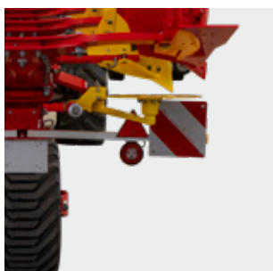
Warntafeln mit Beleuchtung
