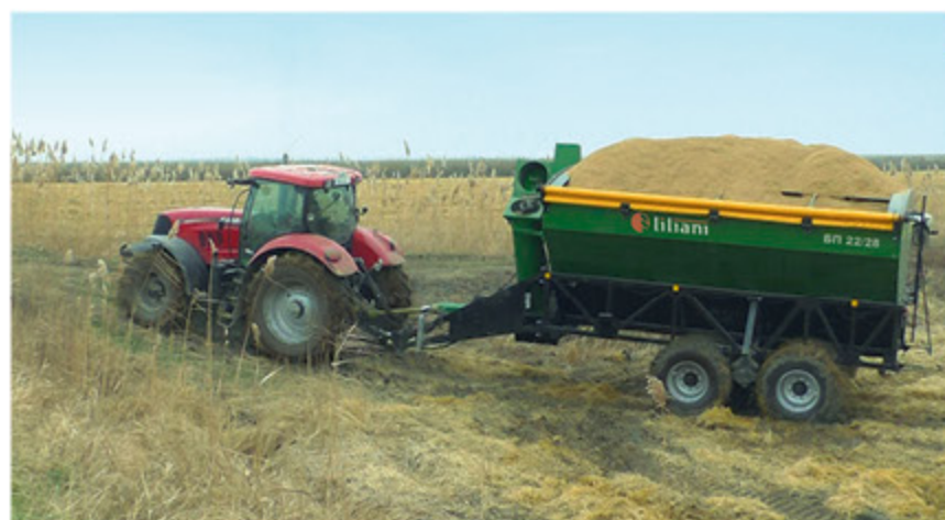
Одновременная загрузка бункера-перегрузчика «Лилиани» семенами и удобрениями. При установке протравителя возможно протравливание семян в момент загрузки в бункер-перегрузчик.
