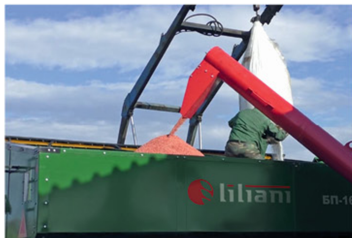
Одновременная загрузка бункера-перегрузчика «Лилиани» семенами и удобрениями. При установке протравителя возможно протравливание семян в момент загрузки в бункер-перегрузчик.
