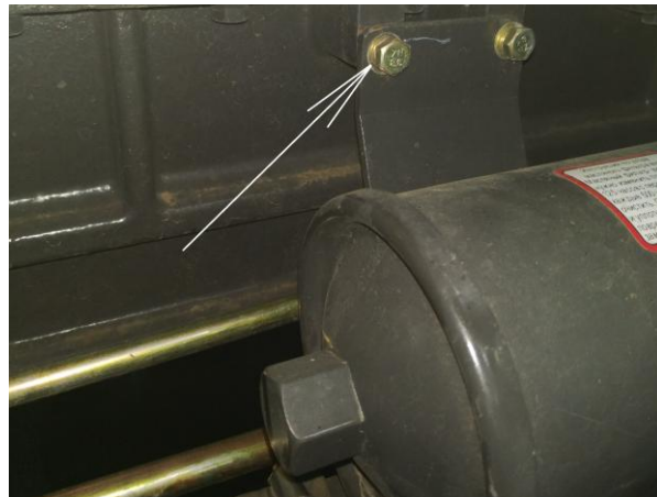
Рисунок 11 – Подсоединение провода(черного) к массе трактора
