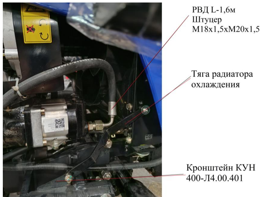
Фото 5 Установка РВД вместо трубки (правая сторона трактора)
