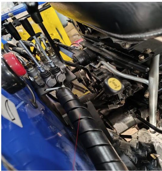
пластиковая защита ф50мм с РВД лежит на поддержке ПЗ20-ЛЗК.00.404
