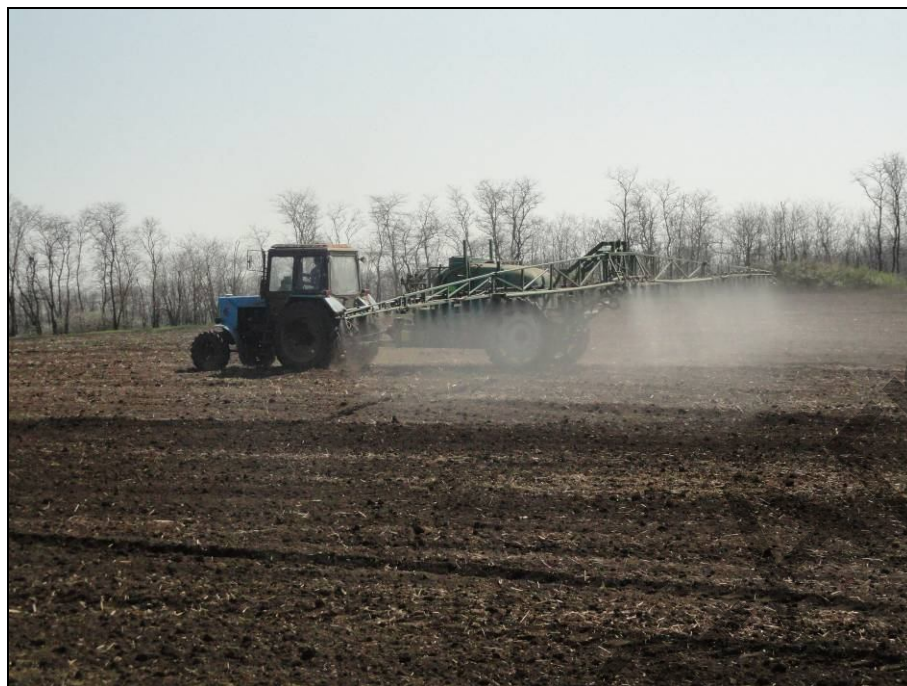
Рисунок 2 – Опрыскиватель полуприцепной штанговый ОПГ 3000 24 МК в агрегате с трактором МТЗ-82.1 в работе на предпосевной обработке почвы при внесении гербицидов
