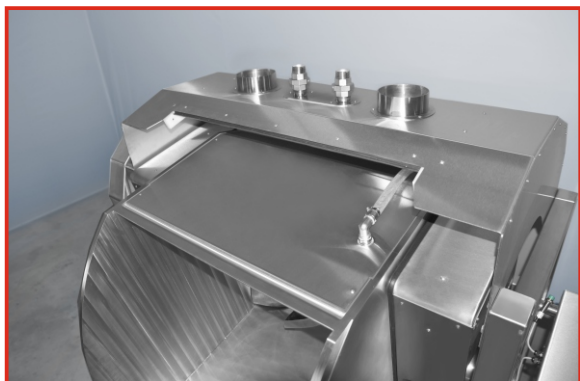
Верхняя крышка дежи с патрубками для загрузки жидких и сыпучих компонентов
