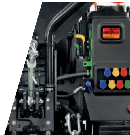
> Bis zu 10 Anschlüsse am Heck und 1 druckloser Rücklauf
