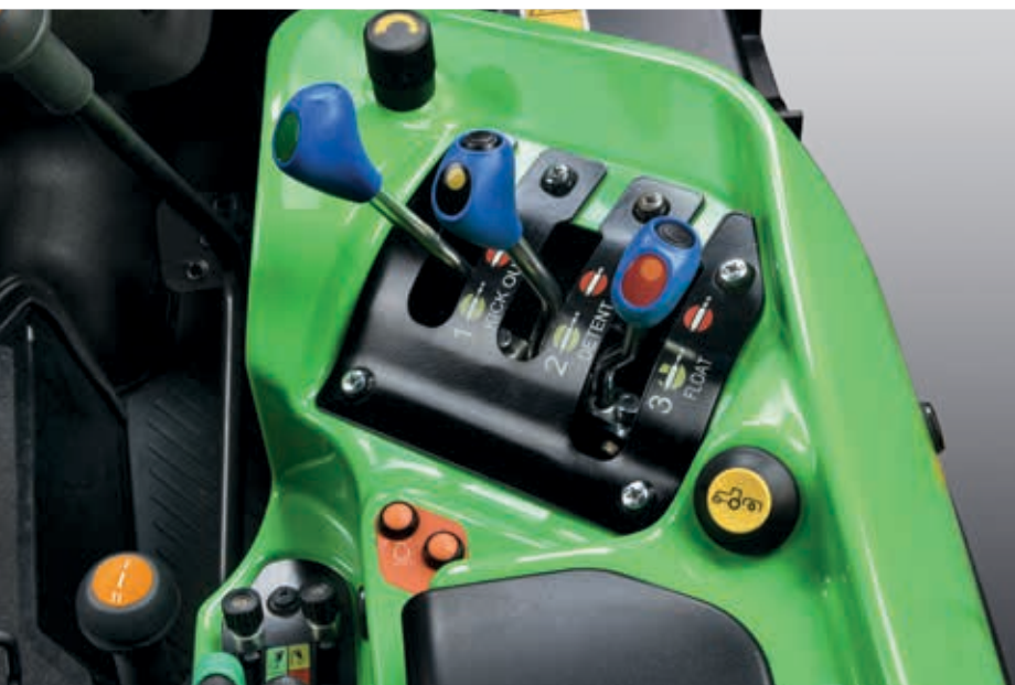
> Leichtes Zuschalten der Heckzapfwelle mit Drucktaste.
