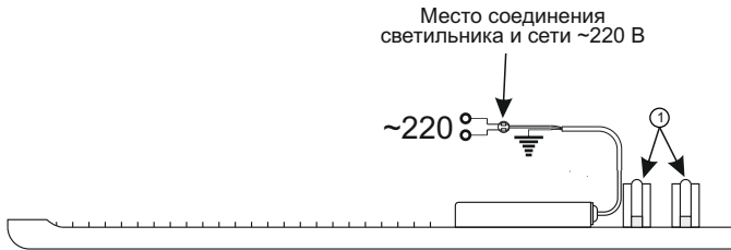
Рисунок 2 — Схема подключения изделия
