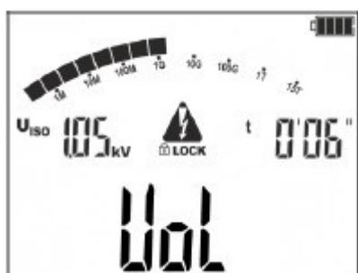
На втором этапе измеряется поперечное сопротивление  $R_{vol}$ .
