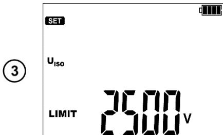
Окончательное напряжение измерения  $U_{iso}$  **LIMIT**.
