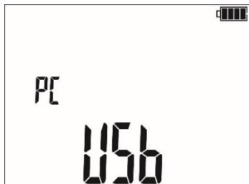
Подключите кабель от порта USB компьютера к разъёму USB измерителя.
