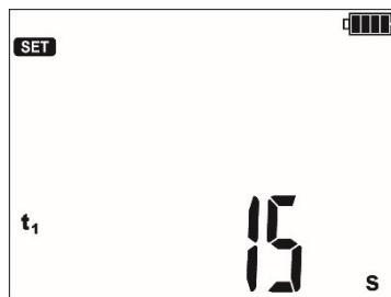
Установка времени  $t_1...t_3$ .
