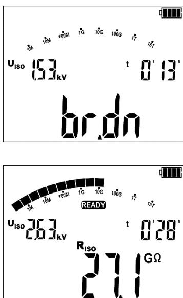
Если в процессе нарастания напряжения произойдет пробой изоляции, то измеритель отобразит:
