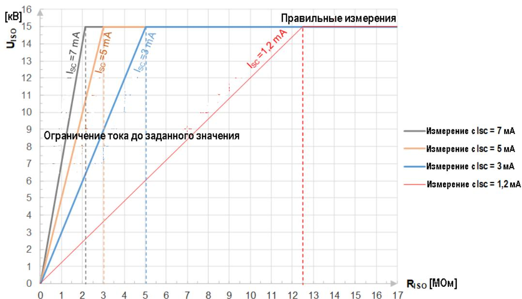
Фактическое напряжение измерения  $U_{iso}$  в функции измерения сопротивления изоляции  $R_{iso}$
