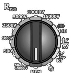
Установите поворотный переключатель выбора функций в положение **MEM**.
