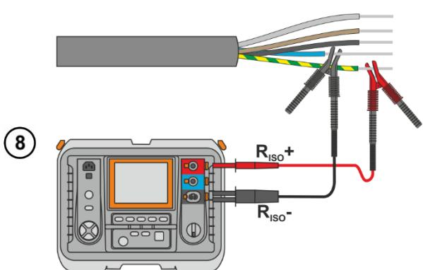
Подключите измерительные провода согласно рисунку.
