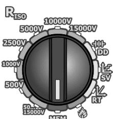
Установите поворотный переключатель выбора функций в положение **MEM** и нажмите на клавишу **MENU**.
